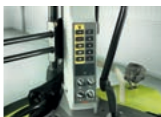
Regímenes de la toma de fuerza y regulación electrónica del elevador ajustables en el poste B
