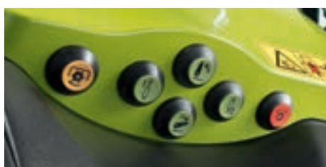
Elementos externos de mando para el elevador trasero, la toma de fuerza y un distribuidor hidráulico a elegir (sólo CEBIS)
