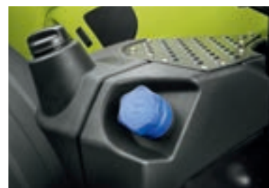
Depósito de combustible de 455 l con un depósito integrado de 42 l de urea
