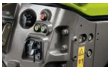
Manejo externo para el elevador delantero y un distribuidor hidráulico con el equipamiento CEBIS
