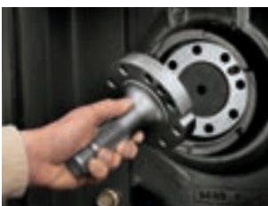
Cambio sencillo de la boquilla de la toma de fuerza
